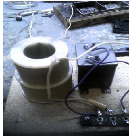
Рисунок 7. Катушка с конденсатором на НЧ.
