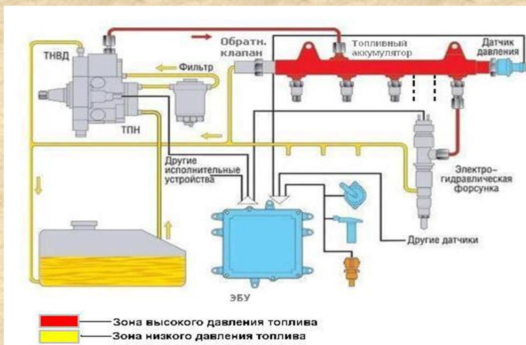
Рис.1.1. Устройство топливной системы
